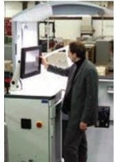
PERFECTO zeichnet sich durch eine sehr Bedienungsfreundliche Benutzeroberfläche aus, ergänzt durch eine "Fast-Setup" Funktion und ein ausgereistes und funktionales Defect-Detection Verwaltungspaket.
